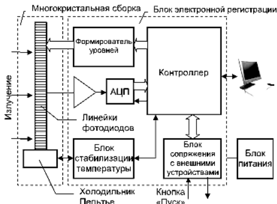
Рис.2.5. Структурная схема анализатора МАЭС
